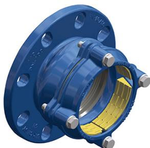
Adaptateur de brides PN10/16 pour tubes plastique PE dans la gamme de DN50/OD63 - DN400/OD400. Verrouillage mécanique par bague. Le verrouillage du tube en plastique PE est réalisé par le serrage des boulons. L'adaptateur à bride pour PE peut être installé dans les réseaux de tubes PE jusqu'à une pression de PFA16 bar. Les composants en contact sont agréés ACS conformément à l'arrêté du Ministère de la Santé Française de mai 1997.
