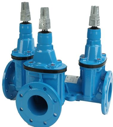
Les ensembles robinets-vannes Type 3 sont des appareils de sectionnement à opercule surmoulé d'élastomère de DN80 à 200 PFA16 destinés à être utilisés en position tout ou rien.
